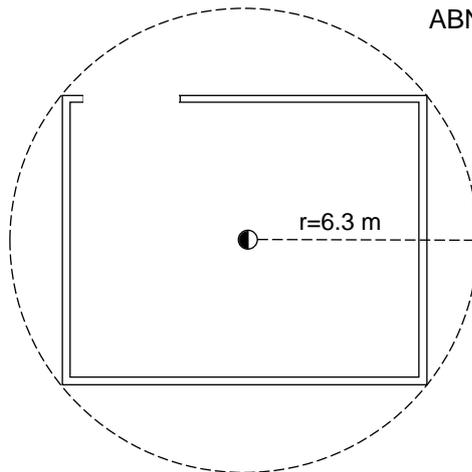
O detector pode ser posicionado no mínimo a **15cm da parede** ou do teto e caso seja necessária a instalação vertical, no máximo a 30cm do teto. Mais detalhes: ABNT NBR 17240:2010.
