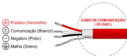
Capacitância máxima – O cabo de comunicação não deve ultrapassar à 120pF por metro, pois, acima disso causará falha de comunicação no sistema.
