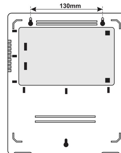
Marque esses furos na **parede\*** para visualizar a posição a ser furada.
