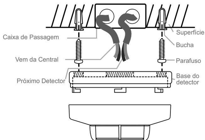
O detector possui uma base de fixação de encaixe rápido. A base deve ser instalada fixada na superfície desejada utilizando os furos de fixação. O centro da base possui espaço para a passagem dos fios de conexão com a central.
