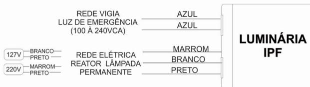
**Ligação da rede Elétrica para iluminação normal**
